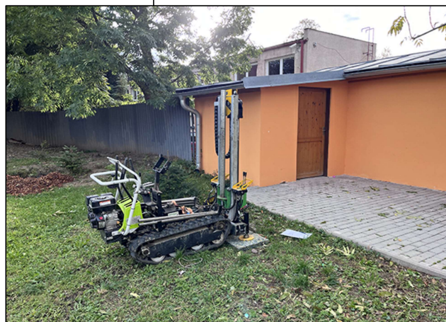
Foto 01: Dynamická penetračná sonda DP-2
